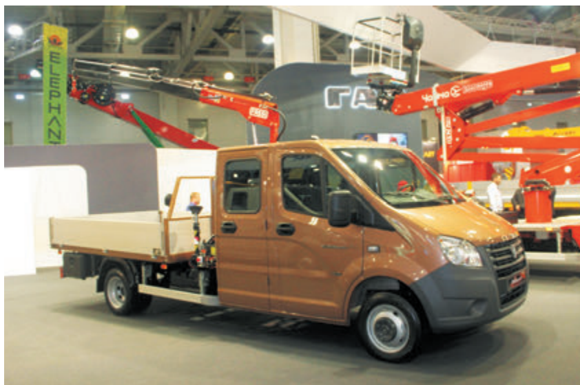
Бортовой автомобиль «ГАЗель NEXT 4,6» с краново-манипуляторной установкой FASSI Micro 90
