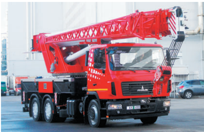
Автокран КС-55727 грузоподъемностью 25 тонн на шасси MAZ-6312C3
