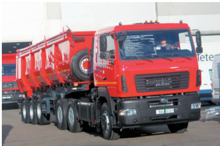
Автопоезд в составе седельного тягача МАЗ-643028 и полуприцепа МАЗ-953003
