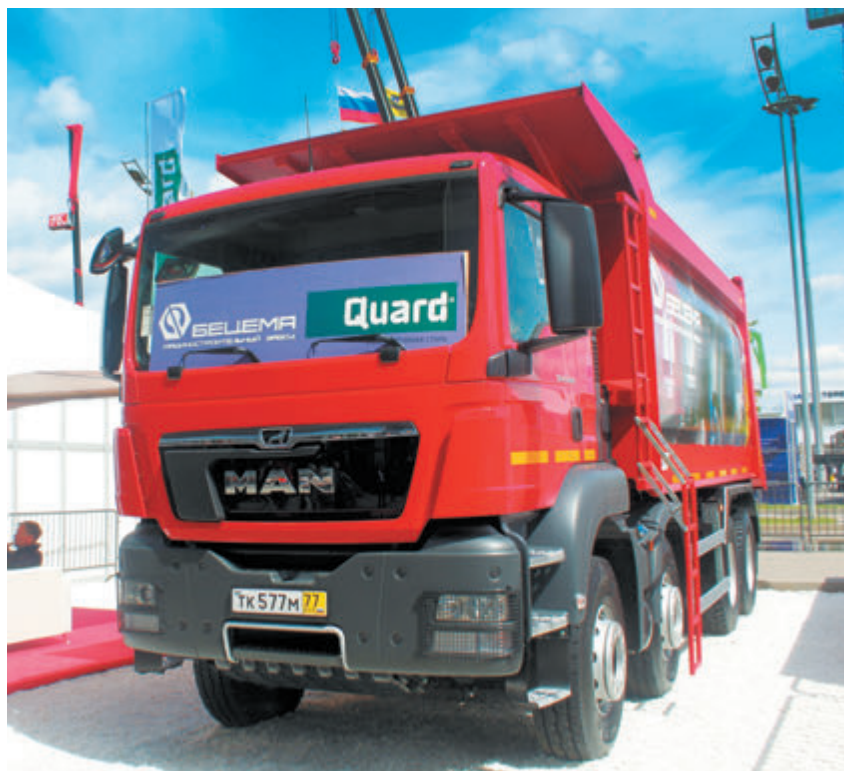
Самосвал-углевоз на шасси MAN TGS 41.440 (8x4) с кузовом компании «Бецема»
