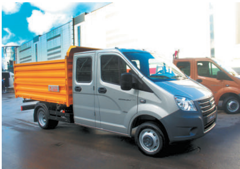
Самосвал ГАЗ-СА3-250711 на шасси «ГАЗель NEXT 4,6»
