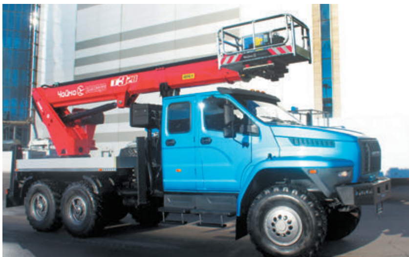
Телескопический автогидроподъемник Socage T328, смонтированный на шасси «Урал NEXT»
