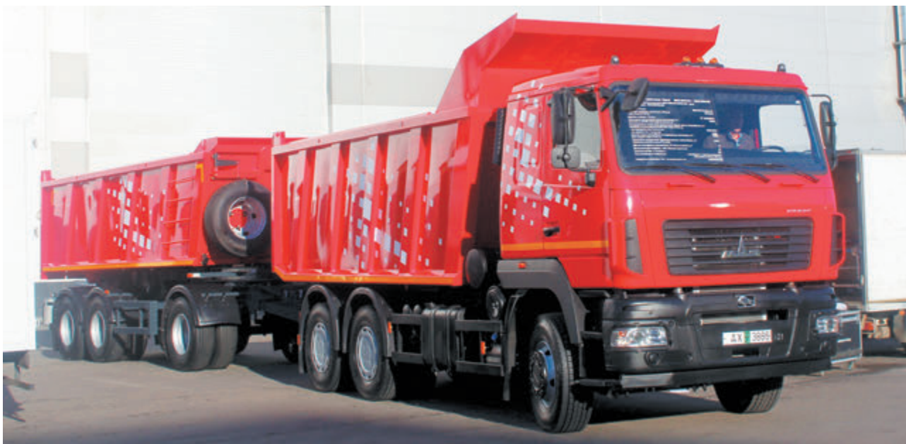
Автопоезд в составе самосвала MAZ-6501C9-8520-005 (6x4) и прицепа MAZ-856102-020
