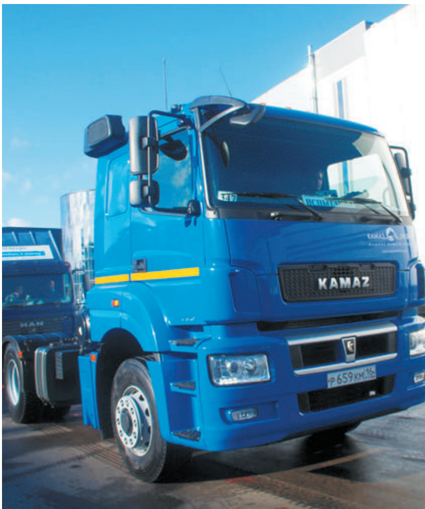
Седельный тягач КамАЗ-54909-090-B5 с гидростатическим приводом переднего моста
