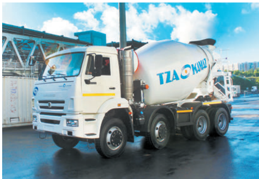
Автобетоносмеситель модели 5814Y7 на шасси КамАЗ-6540
