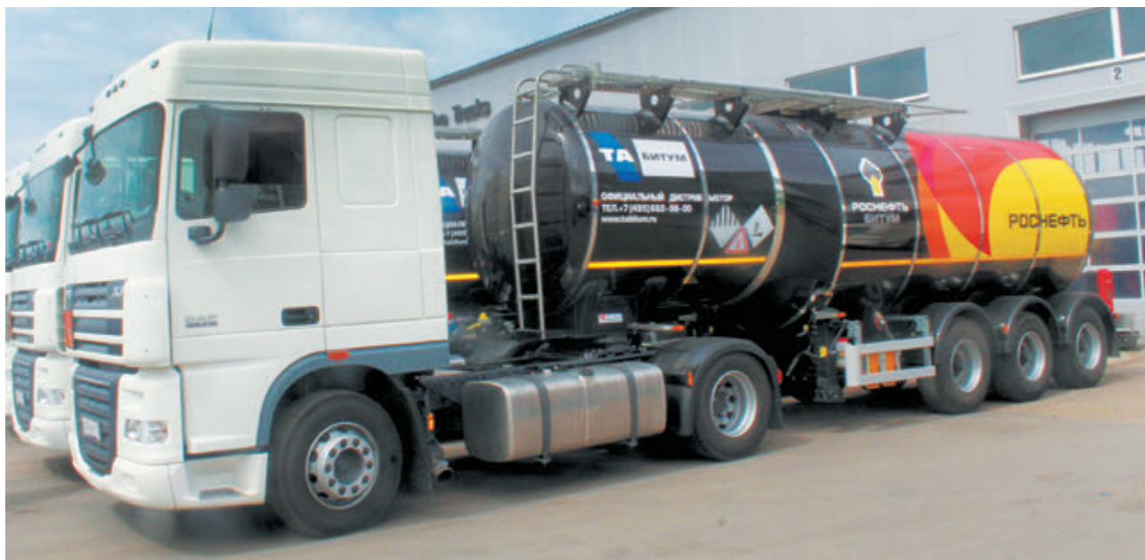
Автопоезд в составе седельного тягача DAF 105.410 и полуприцепа-цистерны SF3B28 брендированной окраски
