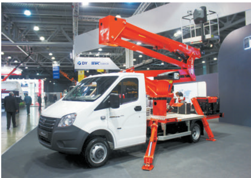
Автогидроподъемник модели 2784BR на базе «ГАЗель NEXT 4,6»
