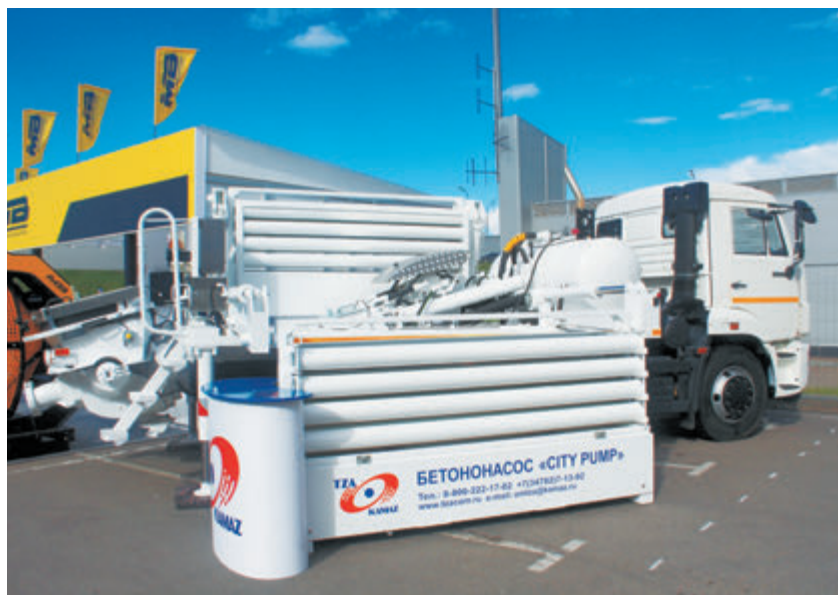
Линейный автобетононасос CityPump на базе КамАЗ-43253
