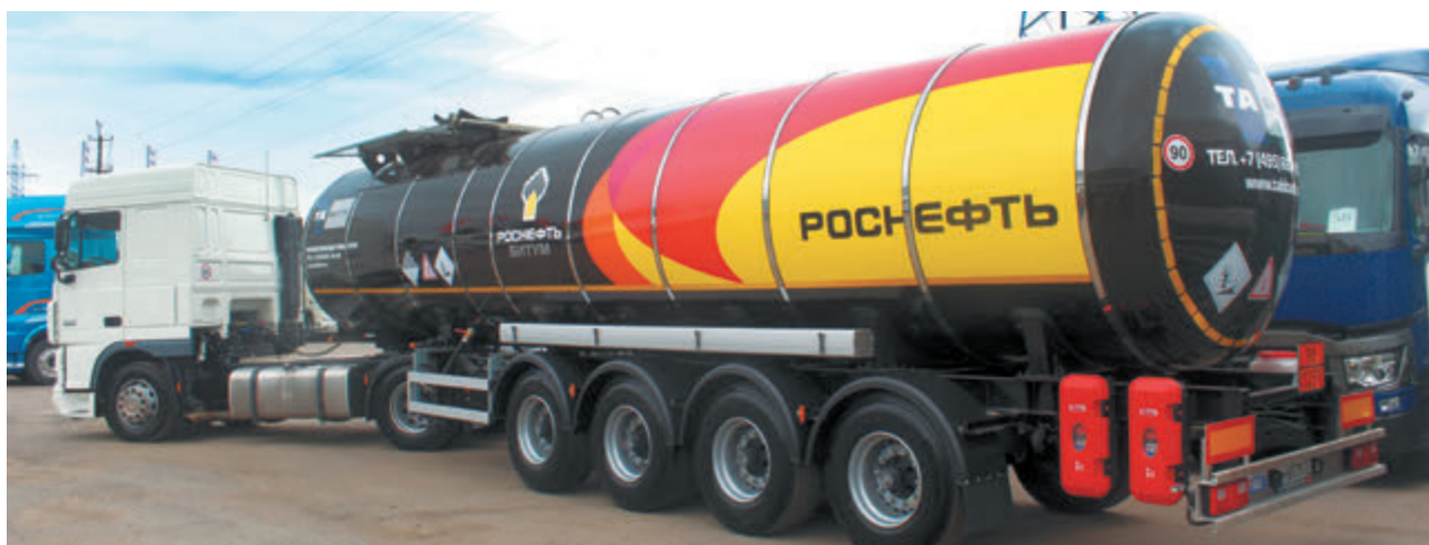
Четырехосная полуприцеп-цистерна SF4B32
